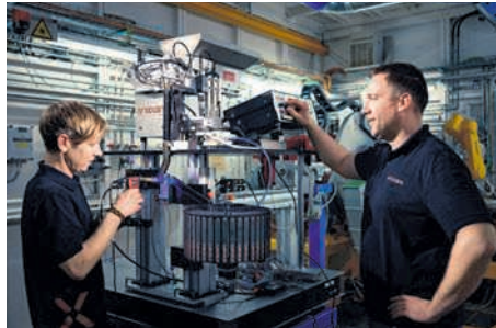
Von der industriellen Fragestellung zur Messung: ANAXAM führt Materialanalysen an der Diffraktionsstrahllinie ADDAMS der Synchrotron Lichtquelle Schweiz SLS am PSI durch.
