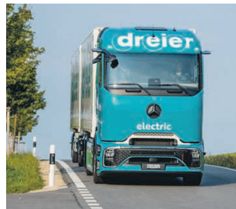
Mercedes-Benz eActros 500 mit Reichweiten von rund 500 KM
