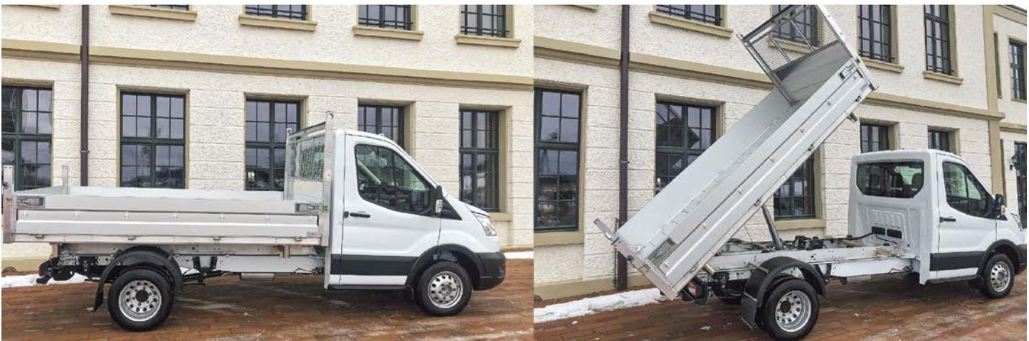
Ford-Nutzfahrzeug mit verbautem Dreiseitenkipper inkl. Unterbau – eine individuelle Lösung des Carrosseriewerks der Emil Frey AG
