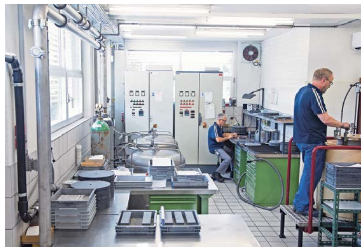
Sicherstellen der Hartmetallqualität im Hause: Hartmetallpulver-Aufbereitung, Pressen der Grünlinge und das Vor- und Fertigsintern
