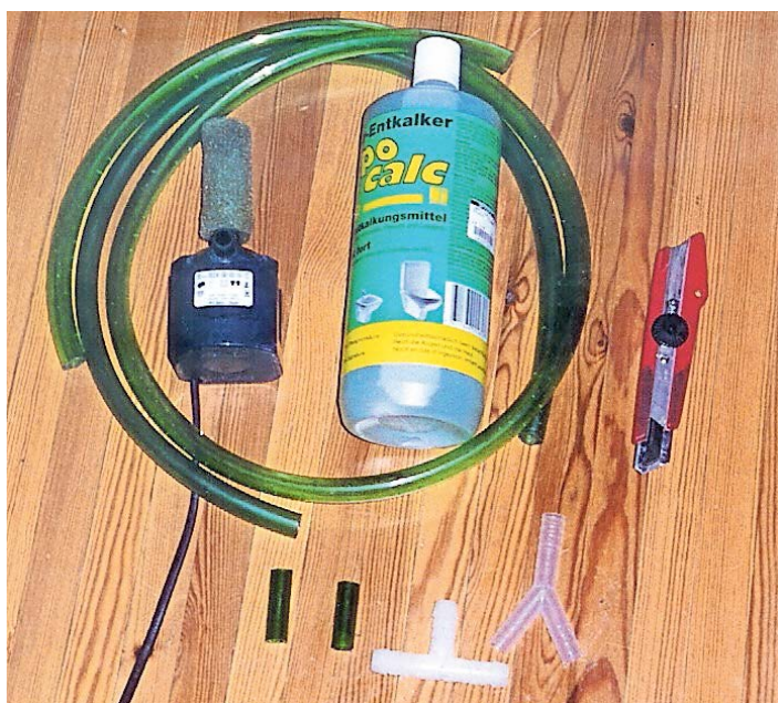
Dies waren die ersten Utensilien nach dem Einfall zu RESCLEAN, welche Priskus A. Theiler als Feldversuch einsetzte – eine einfache Aquarium-Pumpe, Umwälzschläuche und handelsübliches Entkalkungsmittel.
