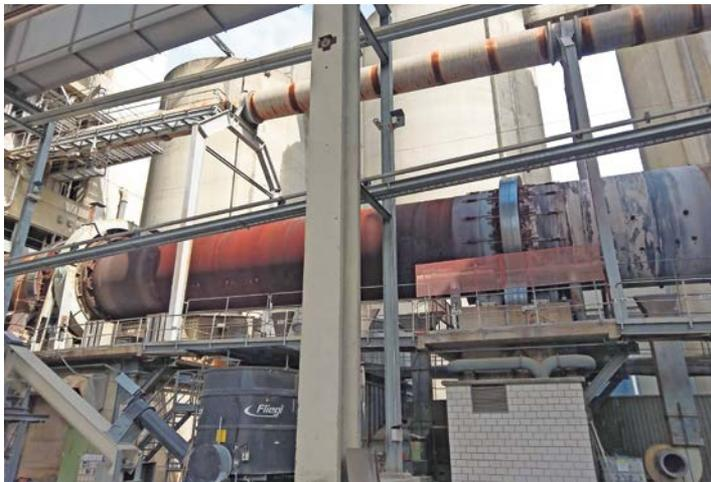
Klinker gebrannt wird. Gemischt mit Gips und Zuschlagstoffen entsteht in der Zementmühle der fertige Zement, der anschliessend lose oder abgepackt in Säcken zum Verkauf bereitgestellt wird. Nebst dem Kerngeschäft bietet die Jura Cement eine Reihe von Dienstleistungen an, wie z.B. Entsorgung von Altpneus und Liefern von Abwärme für Liegenschaften, Schulhäuser und Schwimmbad.
