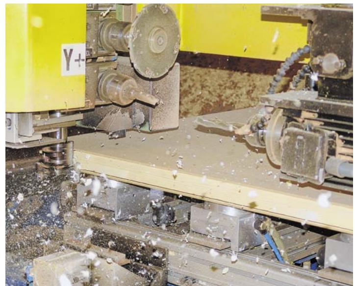
Hobelspäne fliegen heute computergesteuert – Bearbeitung eines Türblatts auf dem CNC-Zentrum.
